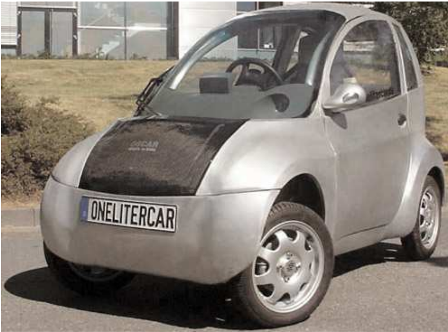
Bild 1: OSCAR, das "Ein-Liter-Auto", ist mit Elektroantrieb unterwegs und bis zu 130 km/h schnell.
