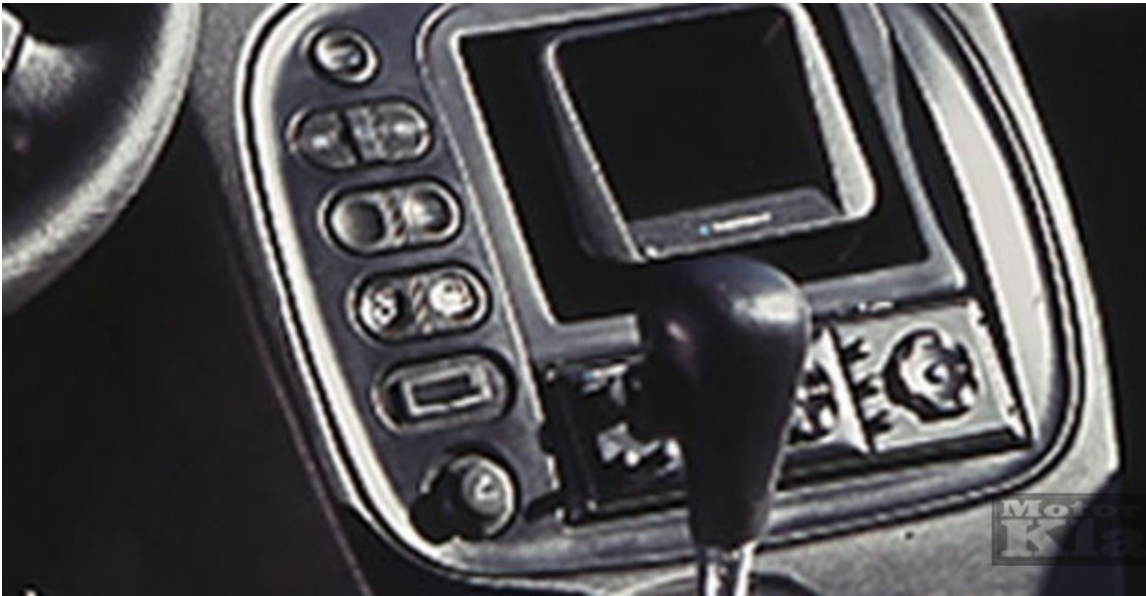
Bild 6: Zieht der Fahrer den Wählhebel in der linken Gasse bis zum Anschlag nach hinten, schaltet sich der Diesel ab, und der Elektromotor übernimmt den Antrieb.
