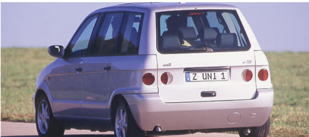
Bild 4: Eine adrette Van-Haut aus Aluminium spannt sich über einen Space Frame, ...
