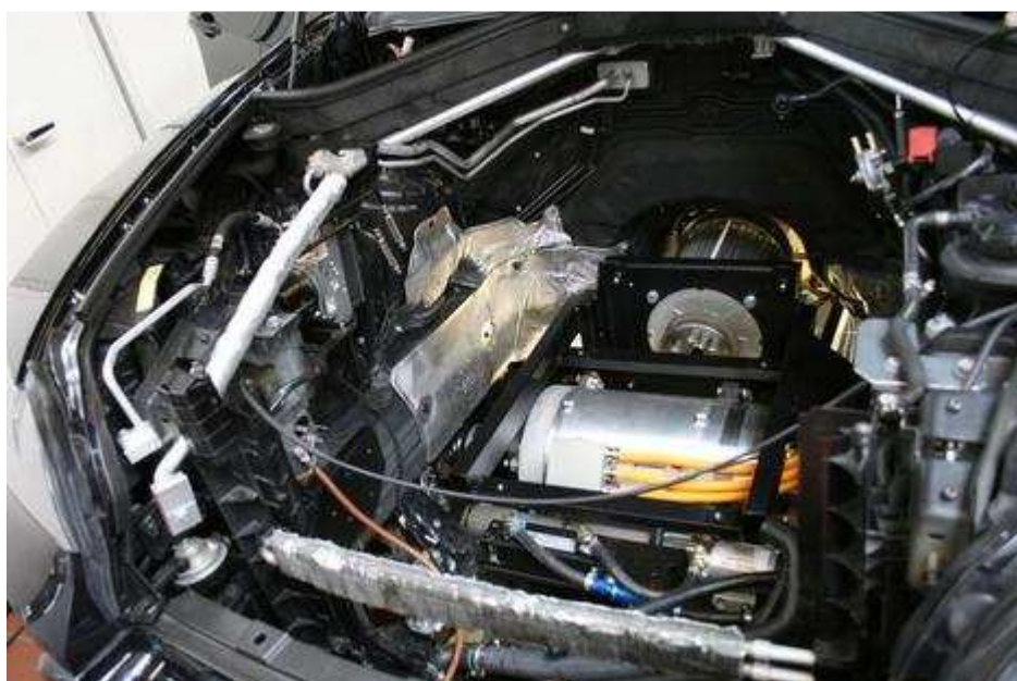
Bild 9: Der vordere Elektromotor mit integriertem Getriebe sitzt in einem Stahlrahmen
