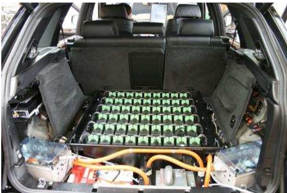
Bild 15: Im Gepäckraum lagern crashsicher die 4800 einzelnen Akkus.
