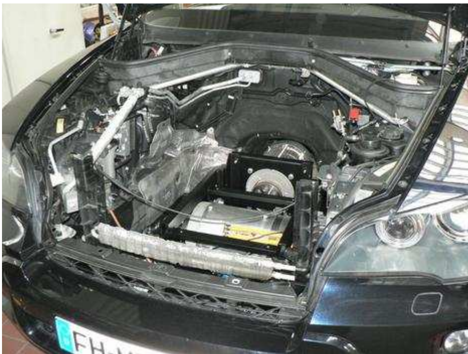
Bild 11: Die beiden Elektromotoren leisten jeweils 100 KW/136 PS und ein maximales Drehmoment von 1250 Nm.
