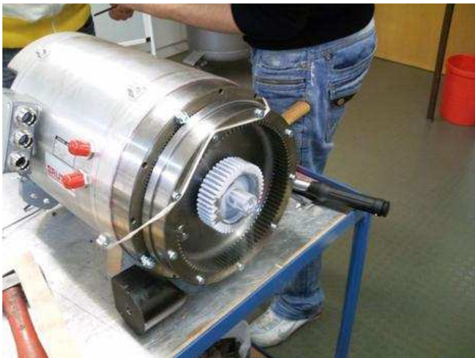
Bild 5: Jeder der beiden Elektromotoren wiegt 100 Kilogramm und leistet 100 Kilowatt.
