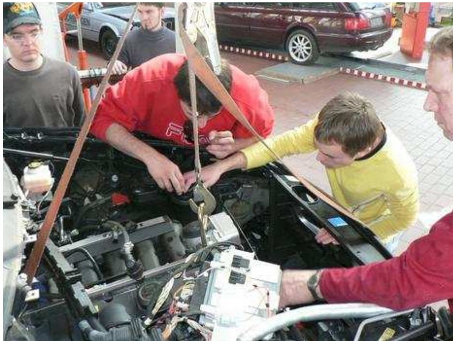
Bild 7: Unter der Motorhaube sitzt ein aufgeladener Kleindiesel mit 30 kW/45 PS Leistung
