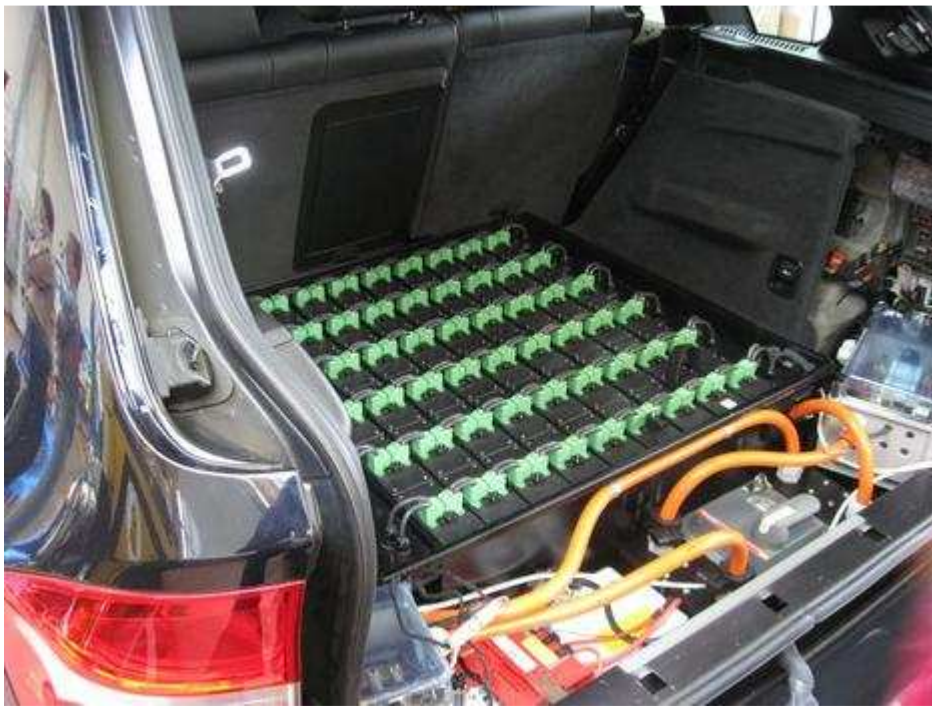
Bild 13: Rein elektrisch kann der MBL X5 Hybrid bis zu 100 Kilometer zurücklegen.
