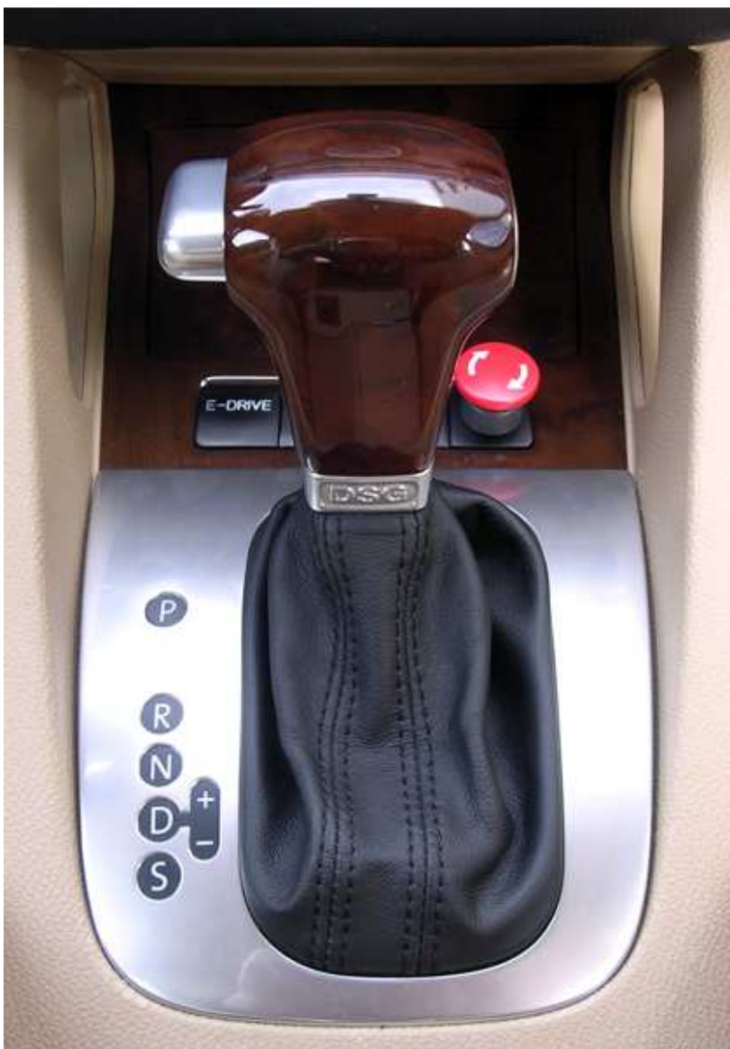
Bild 3: Neue Knöpfe: Vor dem Schaltknüppel befindet sich links die Taste zum Umschalten von reinem Elektro- auf Hybridbetrieb und zurück und rechts der rote Not-Aus-Schalter. Das DSG-Emblem übrigens täuscht; der Golf Twin Drive kommt mit einem Ein-Gang-Getriebe und logischerweise auch nur einer Kupplung aus. Foto: Jürgen Pander
