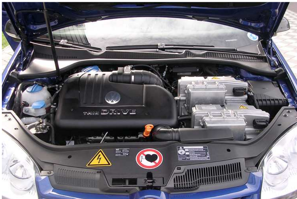
Bild 4: Technik satt: Unter der Haube des Prototypen sitzt ein 1,5-Liter-Dieselmotor mit 102 PS sowie ein 30 kW starker Elektromotor. Zwei weitere je 30 kW starke E-Aggregate sind in den beiden Hinterrädern untergebracht. Im Elektrobetrieb ist dieser Wagen also ein Allradmodell, das wird sich allerdings schon mit den nächsten Twin-Drive-Modellen ändern. Foto: Jürgen Pander
