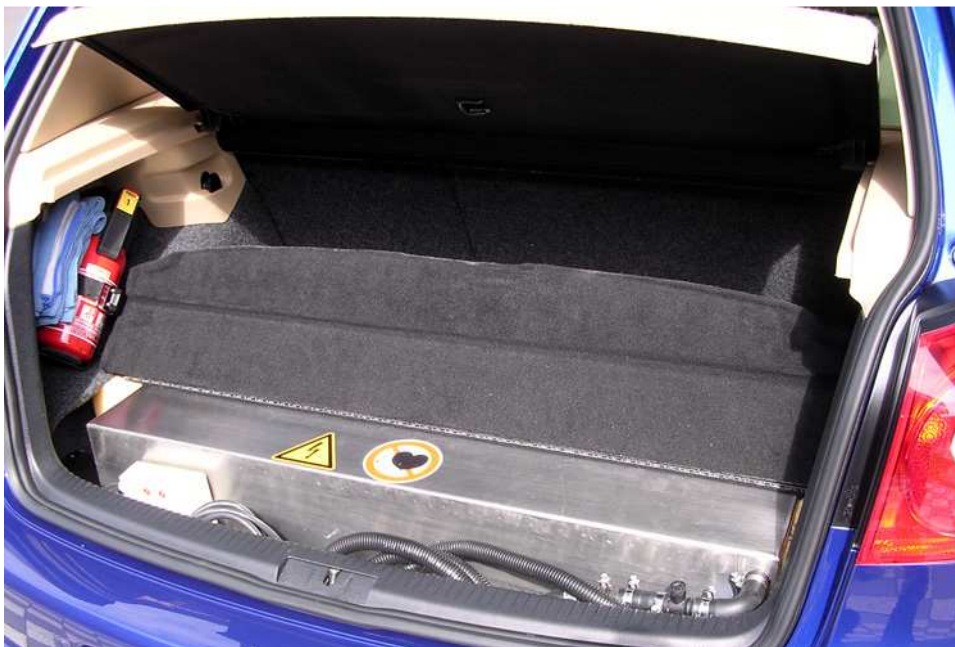
Bild 2: Saftspender: Im Kofferraum ist die rund 150 Kilogramm schwere Lithium-Ionen-Batterie des französischen Herstellers Saft untergebracht. Im Flottenversuch wird VW später Batterien von vier verschiedenen Firmen ausprobieren. Foto: Jürgen Pander
