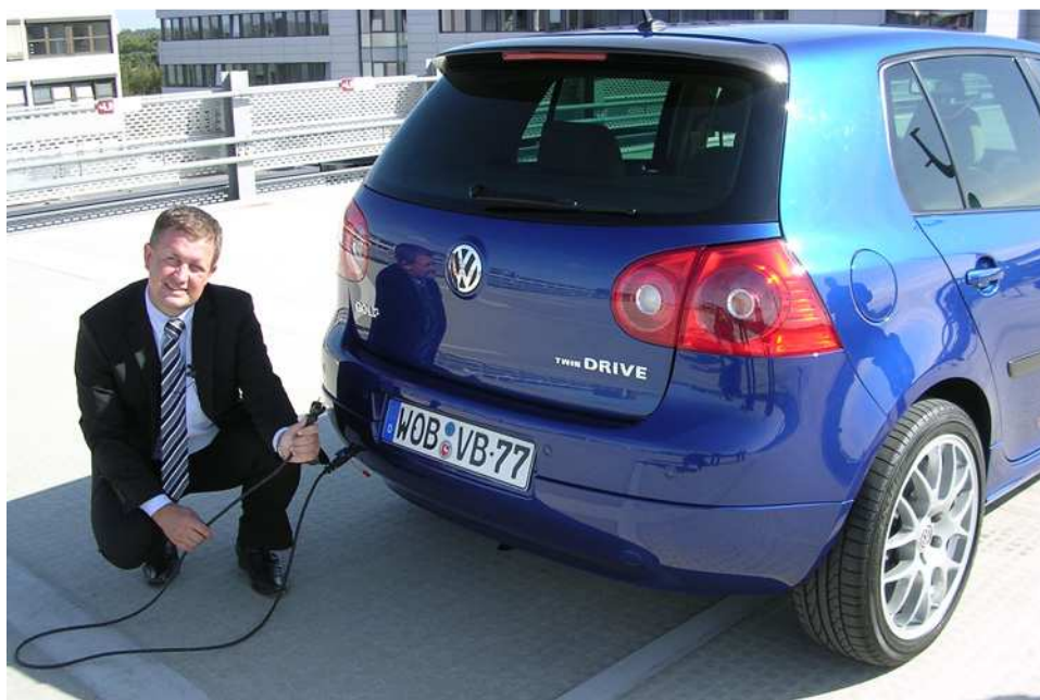
Bild 6: Auto online: Vorne und am Heck des VW Golf Twin Drive befinden sich Stromanschlüsse, mit denen die Batterie des Wagens mit einer normalen Steckdose verbunden werden kann. Nach circa drei bis dreieinhalb Stunden ist der leere Akku wieder voll. Foto: Jürgen Pander
