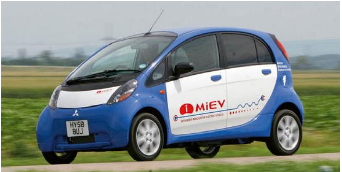
Bild 5: Mitsubishi i MiEV mit Lithium-Ionen-Akkus und 47 kW (63 PS).
