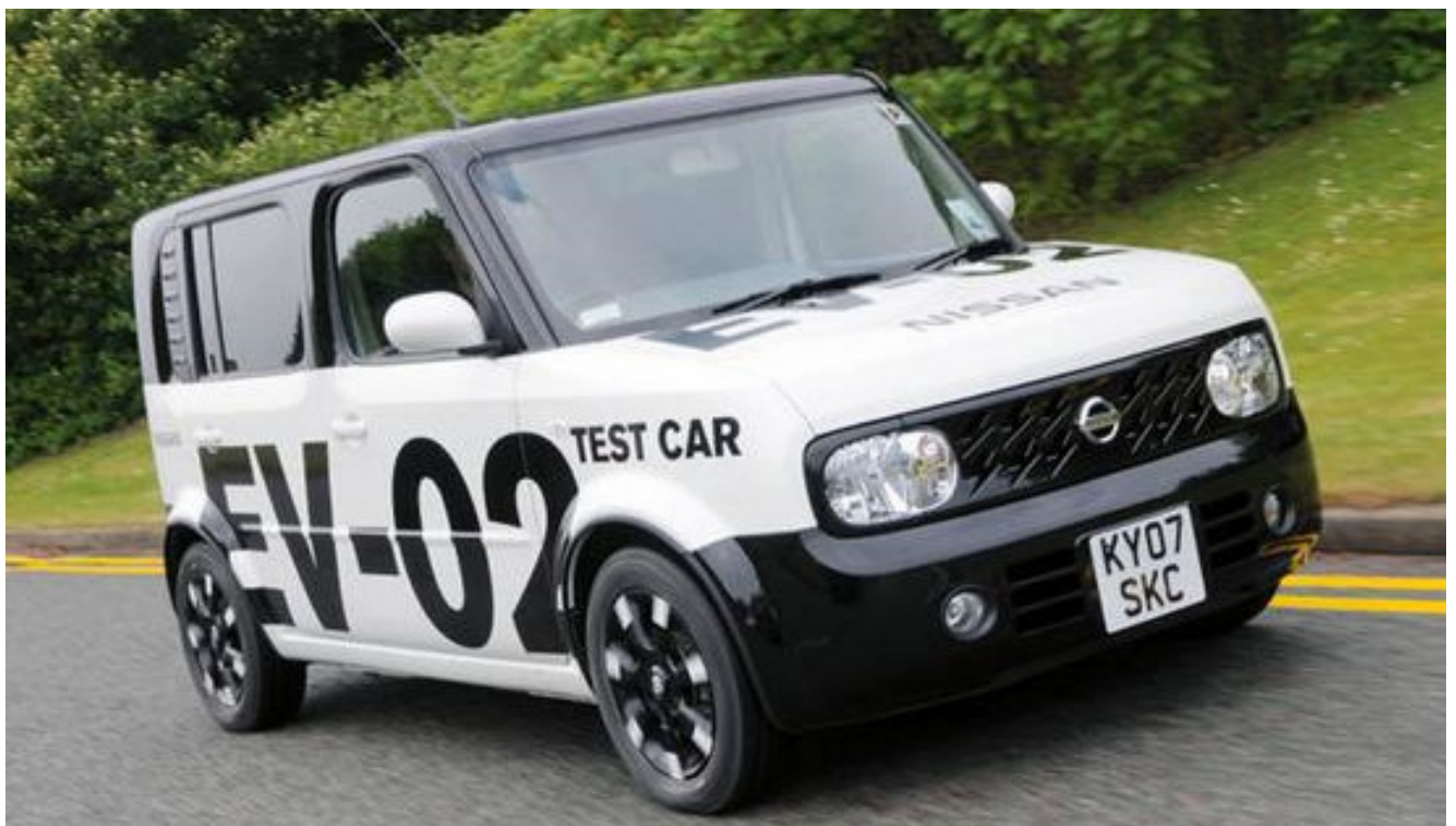
Bild 3: Der Nissan EV-02, Versuchsträger mit 81 kW (110 PS) –Elektroauto mit Lithium-Ionen-Akkus
