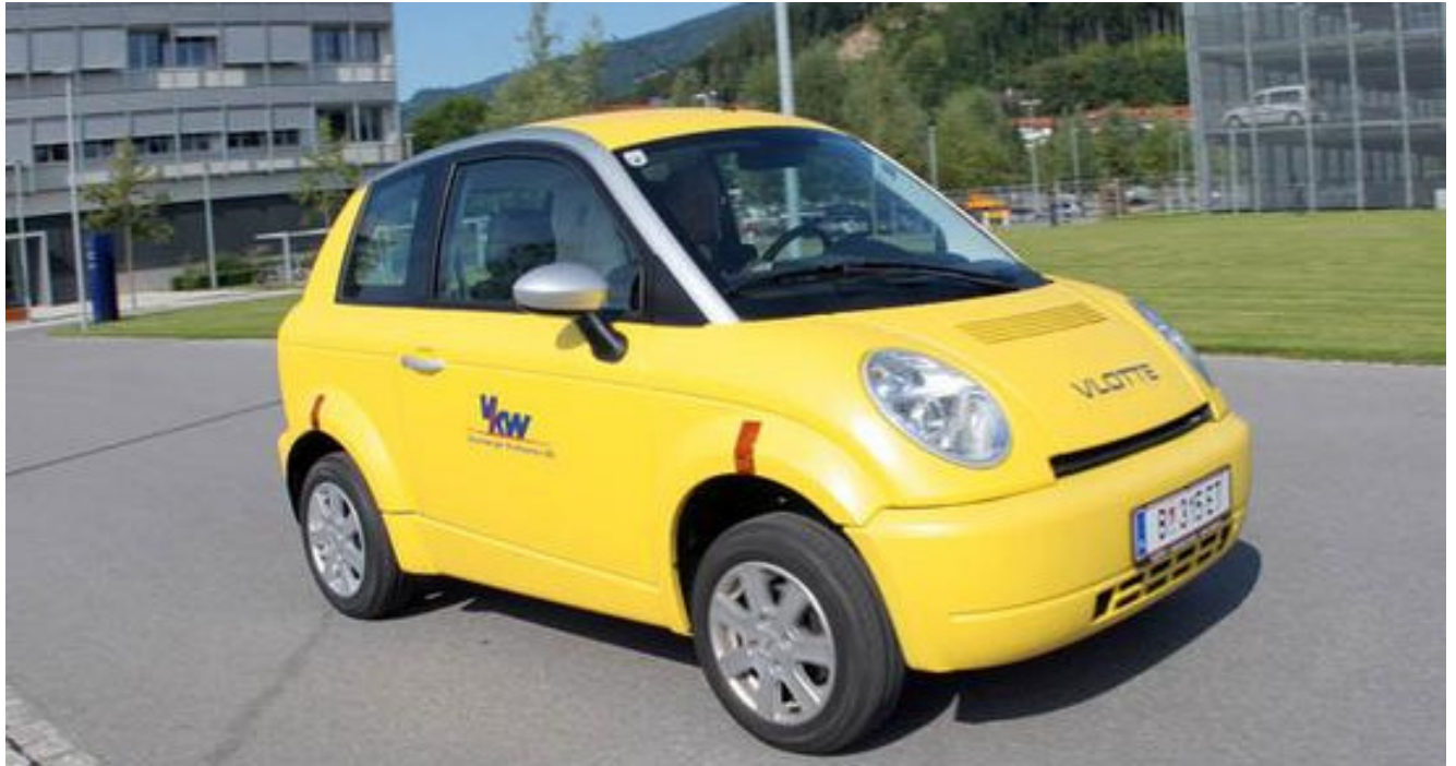
Bild 4: Th!nk city mit 34 kW (46 PS) und Nickel-Akkus.
