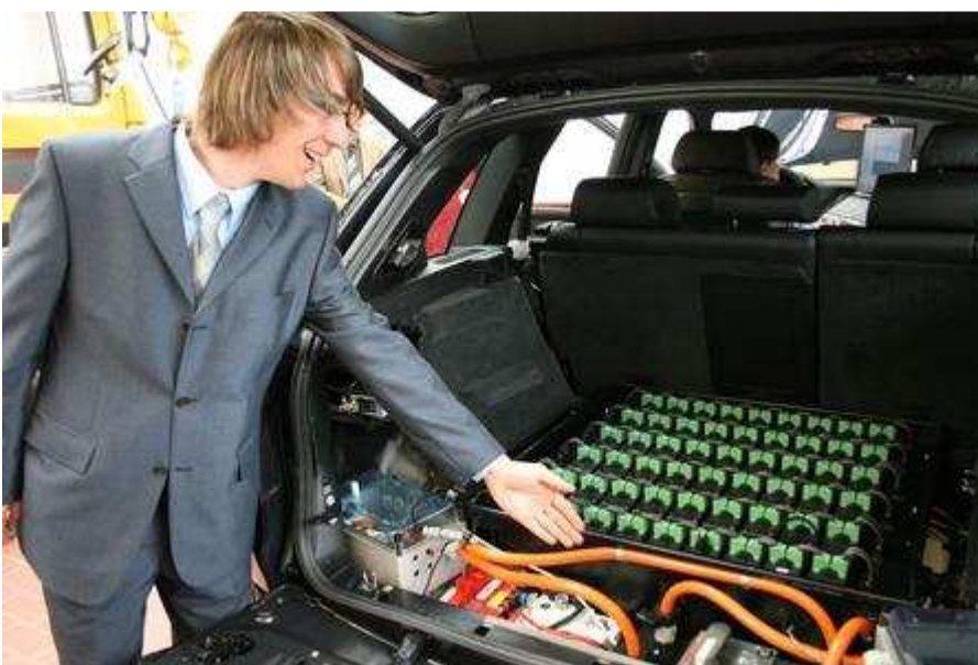
Bild 4: Hybrid-X5 der FH Landshut; Traktionsbatterie mit 4800 Li-Ion-Zellen. Foto: Grundhoff
