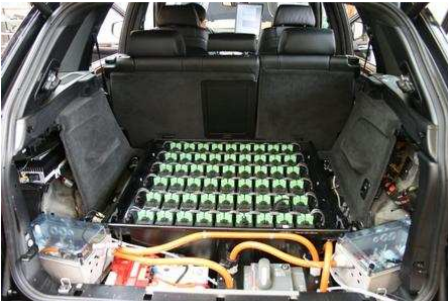
Bild 15: Hybrid-X5 der FH Landshut; Traktionsbatterie mit 4800 Li-Ion-Akkus. Foto: Grundhoff
