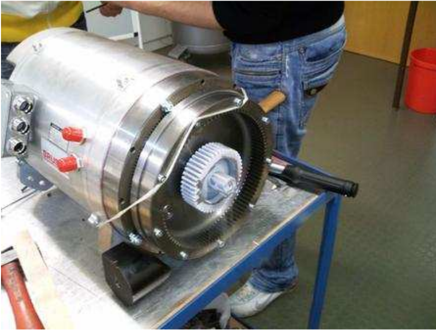
Bild 8: Hybrid-X5 der FH Landshut; Endmontage der Fahrtriebe Foto: Grundhoff
