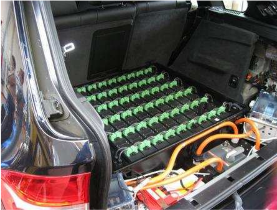
Bild 11: Hybrid-X5 der FH Landshut; Traktionsbatterie, eingebaut unter dem Kofferraumboden. Foto: Grundhoff
