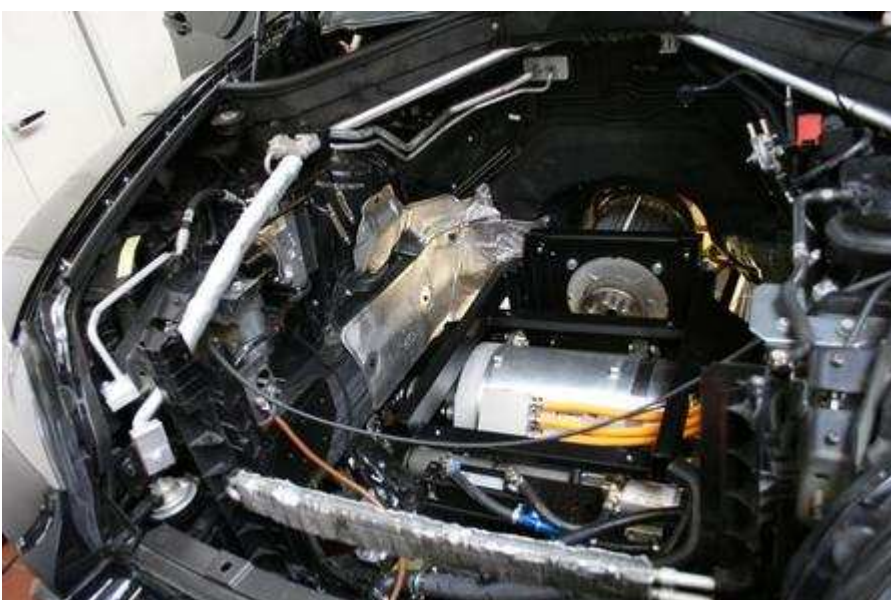
Bild 10: Hybrid-X5 der FH Landshut; Antriebskomponenten im Motorraum Foto: Grundhoff
