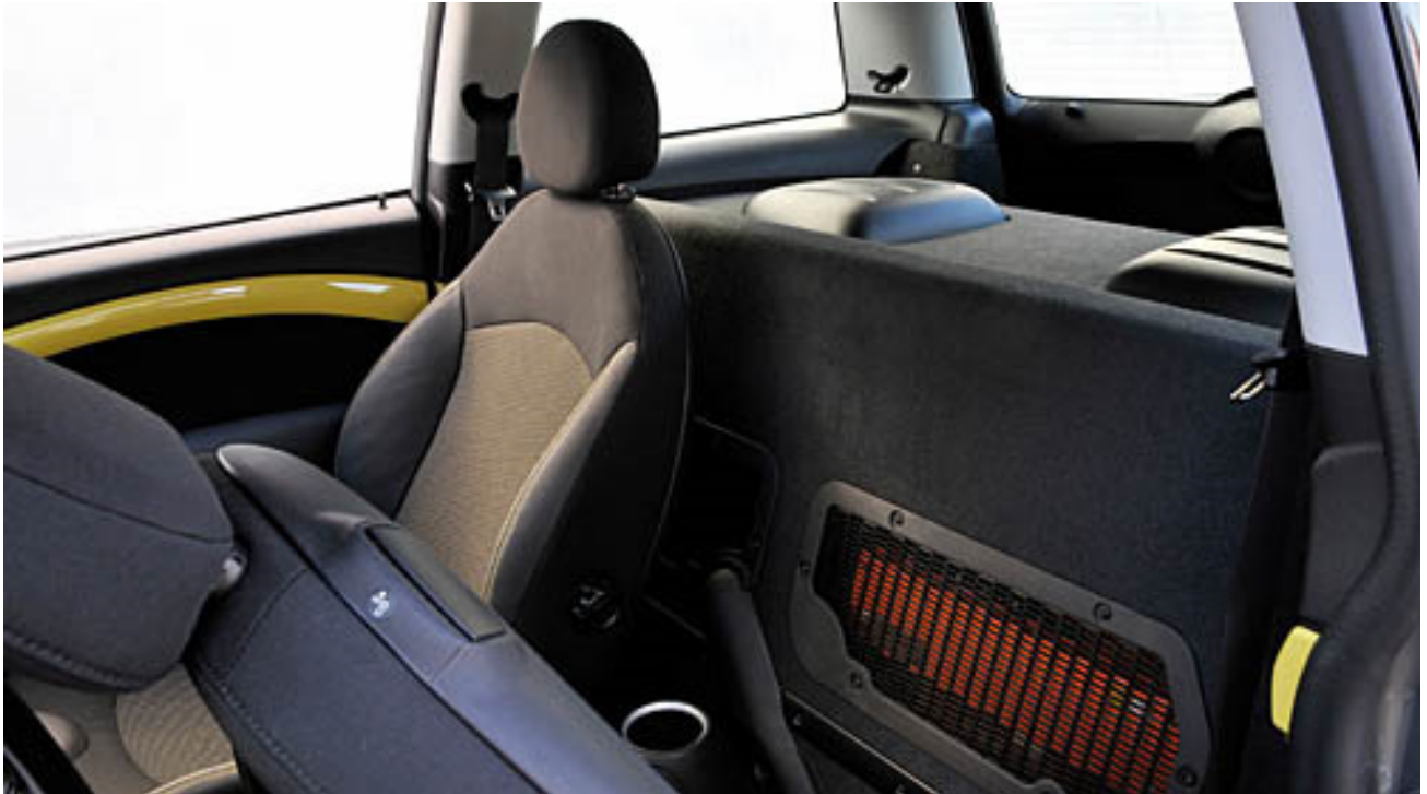
(c) Werk Der Akku hinter den Sitzen im Mini E
