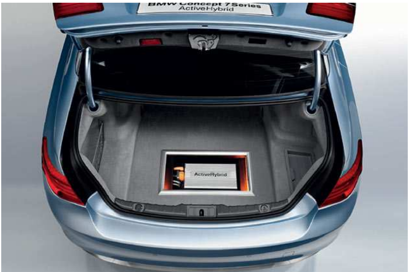
Bild 4: Die kompakte Lithium-Ionen-Batterie ist im Kofferraum untergebracht. Offiziell ist das Auto noch eine Studie; die Markteinführung dürfte im Herbst 2009 erfolgen. Verbrauch: 9,7 statt 11,4 Liter.
