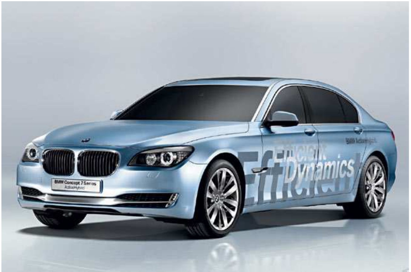
Bild 1: BMW zeigt ein weiteres Hybrid-Modell. Der 7er verfügt über einen 407 PS starken Achtzylinder-Benziner und einen 20-PS-Elektromotor, der auch als Generator und Anlasser dient.
