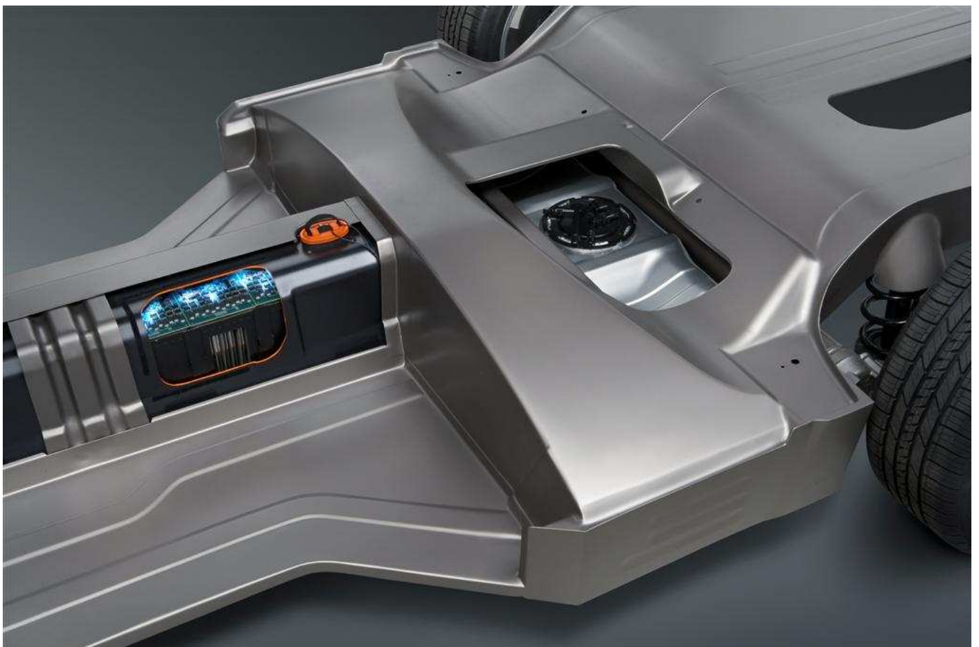
Bild 3: Opel Ampera: T-förmige 16-kWh-Lithium-Ionen-Batterie von LG Chem. Bildmaterial: Opel
